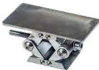
**Домкрат монтажный универсальный НТМ-ДМУ** обеспечивает предварительное уплотнение модулей. Действует по принципу стандартного ромбического домкрата. Увеличивает расстояние между рамой и последним рядом модулей для упрощения установки пресс-блоков
